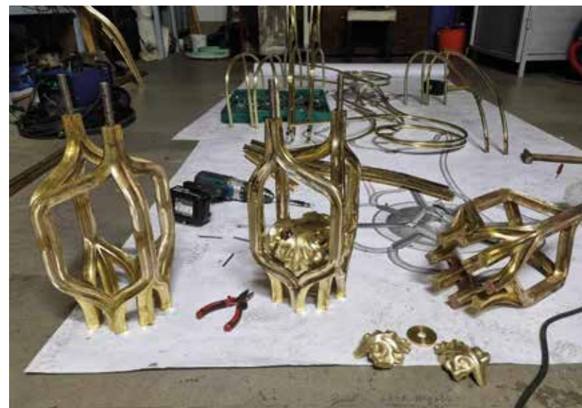
12. ábra | Munkafolyamatok: összeszerelés, villanszerelés, lakkozás. A háttérben látható az 1:1-es műhelyrajz, amely az összeszerelést is segítette / fotó: Laczik Csaba
