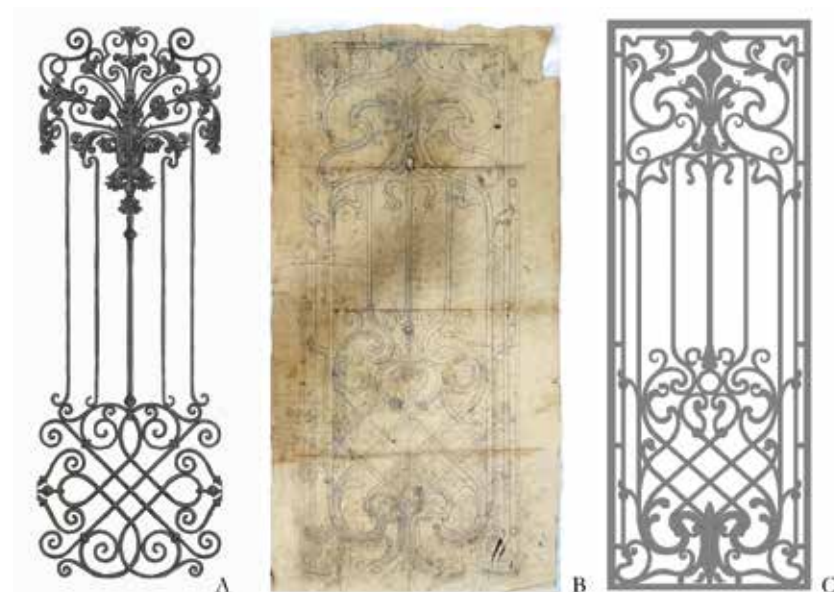
5. ábra | A 4. képen lévő rács rekonstrukciós tervezésének fázisai.
