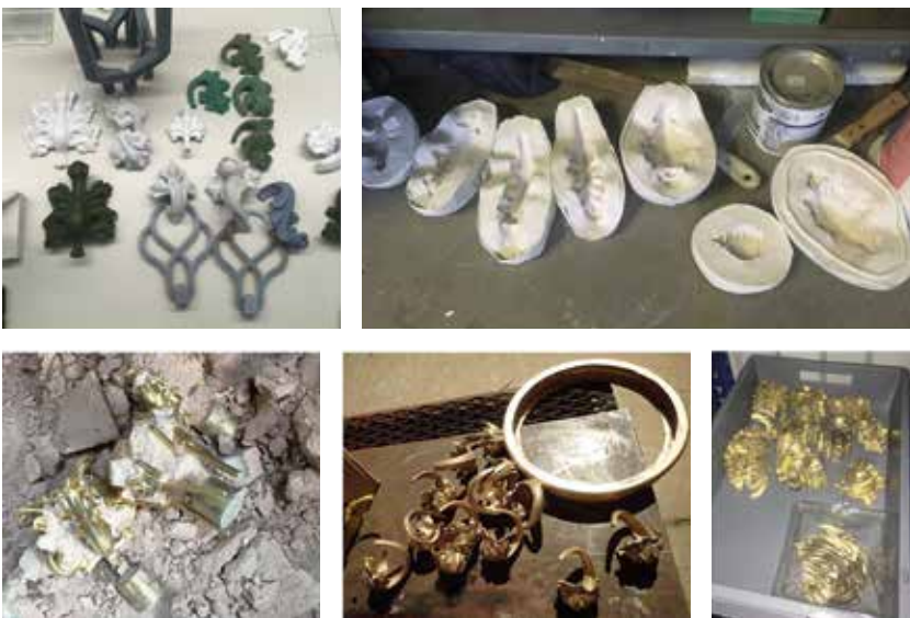
11. ábra | Munkafolyamatok: alkatrészgártás – öntőminta-sokszorosítás, öntés, cizellálás, csiszolás, polírozás / a szerző fotója
