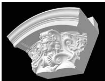
11. ábra | Honvéd Főparancsnokság – rekonstrukció, szegmensíves ablakszemöldök szobrászdísz, tagozatok – előmarás / ALAKart 2024
