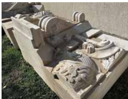
11. ábra | Honvéd Főparancsnokság – rekonstrukció, szegmensíves ablakszemöldök szobrászdísz, tagozatok – előmarás / ALAKart 2024
